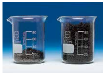
De expansie begint volop bij een temperatuur vanaf 300°C waarna het volume tot 250 keer groter wordt.
